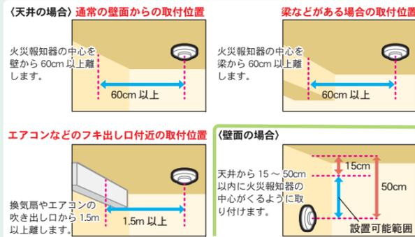
・設置義務化から10年が経過しています。点検ボタンを押すか、点検ひもをひっぱり定期的な作動確認をください。また、電池切れなどで、火災を感知しなくなることがあるため、10年を目安に交換してください。
